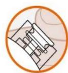
Stellen Sie sicher, dass der **weiße Kolben** ganz unten ist.
